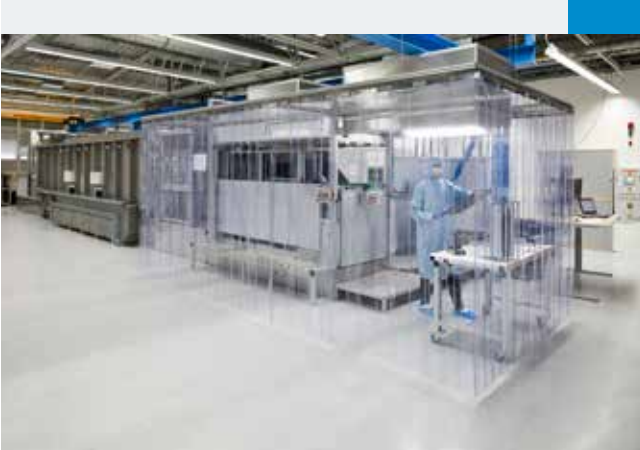
Inline-Epitaxieanlage ProConCVD im NexWafe Technologiezentrum
