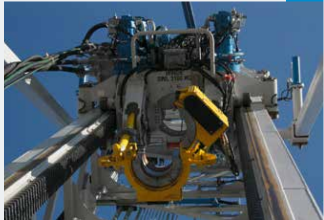
Der Hubschleitten wird innerhalb des Zahnstangenmasts per Fernbedienung auf und ab bewegt.
